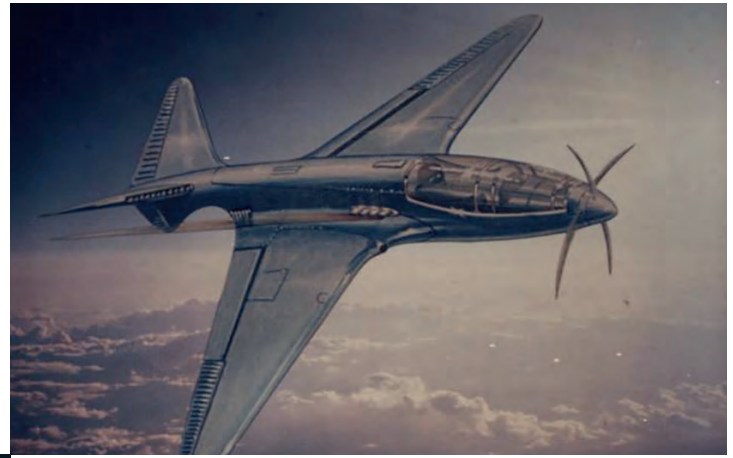
Rekordverdächtig: Das Bugatti-Flugzeug sollte mit 1000 PS eine Geschwindigkeit von 768 km/h erreichen – hob aber nie ab
